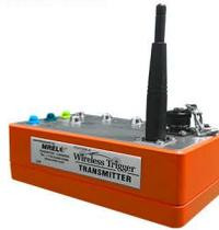
El **Blaster's PWT™** Portable Wireless Trigger permite a los operadores enviar una señal de disparo a sus cámaras u otros instrumentos desde una distancia remota sin necesidad de utilizar cables de disparo largos. Esto permite a los usuarios posicionar una o más cámaras más cerca del punto de voladura de lo que podría considerarse un lugar seguro para el usuario, y luego activar las cámaras de forma inalámbrica desde una distancia de hasta 500 m (1640 pies).
