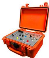
O **MicroTrap™** VOD/Data Recorder é um gravador de Dados e de VOD que possui 1 canal para gravação da velocidade de detonação dos explosivos e opcionalmente outros 4 canais para gravação de qualquer sensor que emita um sinal de  $\pm 10$  volts. Se você precisa medir a VOD ao longo de uma coluna de explosivos continuamente ao longo de um ou mais furos por teste, então o MicroTrap™ é a sua escolha confiável.
