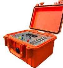
L'enregistreur **DataTrap II™** Data/VOD Recorder dispose de 8 canaux qui peuvent être paramétrés pour enregistrer la vitesse de détonation des explosifs (VOD) ou tout capteur qui émet un signal de sortie de  $\pm 10$  V (vibration, pression, contrainte). Si vous avez besoin d'un enregistreur universel robuste capable, par mesure, d'enregistrer une grande variété de capteurs et également d'enregistrer les VOD de nombreux échantillons d'explosifs et/ou de trous de mine, pensez au DataTrap II™.
