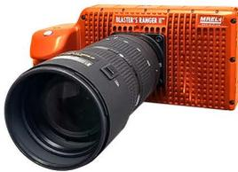
La **Blaster's Ranger II™** est une caméra vidéo numérique haute vitesse dotée d'un écran tactile LCD ultra lumineux de 178 mm (7 pouces) et d'une batterie interne pour une fonctionnalité totale sans utilisation de contrôleur ou de batterie externe. La Blaster's Ranger II™ est le successeur de la caméra la plus populaire au monde pour l'enregistrement des tirs de mines dans les mines et les carrières. Il suffit simplement de viser et de filmer pour obtenir une vidéo d'excellente qualité.
